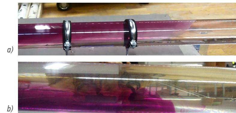
Рисунок 2 - Эффект термогравитационного расслоения флюида: а – внедрение горячего флюида; б – внедрение холодного флюида.
